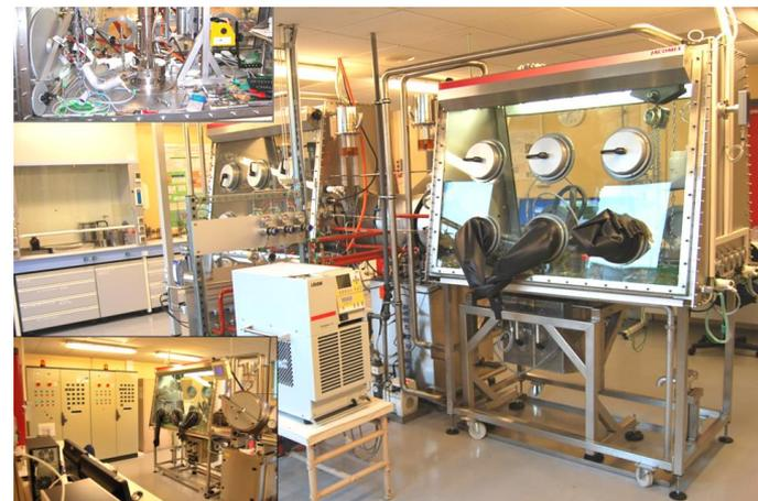
Banc d'essais CORRONa a&b (Système étanche en BâG, 2,3 kg de Na, statique, creuset Mo, 30 000 h d'essais depuis 2010)
