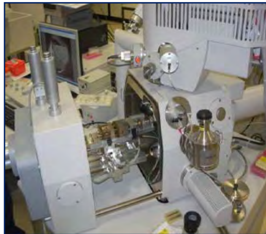
Essai mécanique sous microscope
